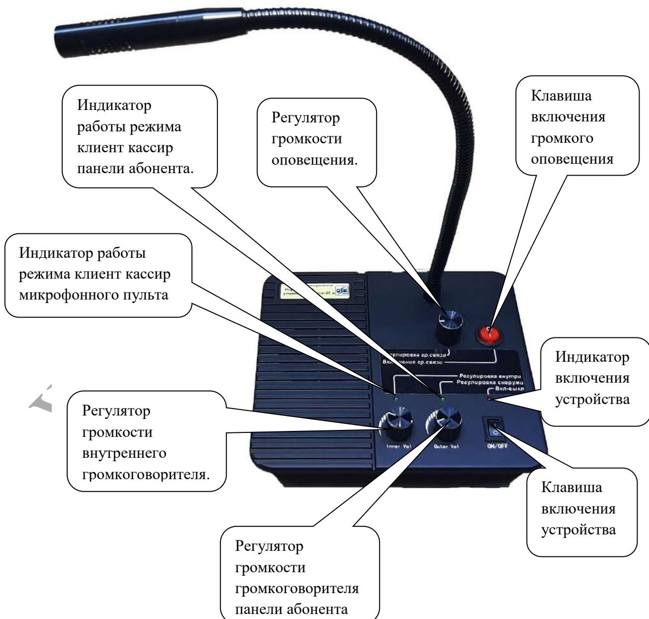
На задней стенке микрофонного пульта расположены разъемы для подключения рупорного громкоговорителя, панели абонента и блока питания.
